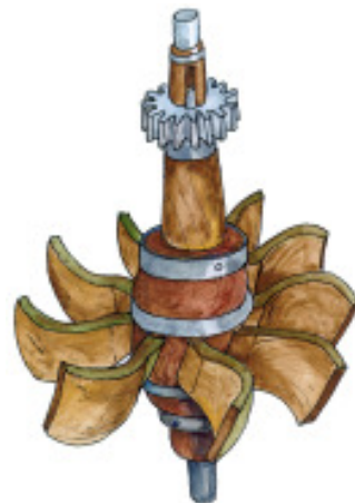
Abb. 40: Laufrad einer Schwarzwälder Hausmühle
